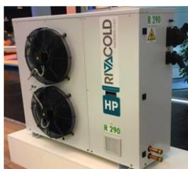
Groupe d'eau glacée au R290. Echangeur à plaques incorporées. Compresseur Scroll R290. Technologie Rivacold avec système de connectique entre le groupe et le ballon tampon. Le module hydraulique est équipé de son ballon tampon, circulateur, vase d'expansion et d'un régulateur Carel pour la gestion du système Waterloop
